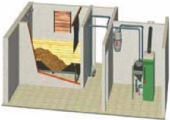
Ist der Lagerort der Holzpellets weiter entfernt, was gerade im Altbaubereich häufig der Fall ist, kommen bevorzugt Saugsysteme zum Einsatz, die eine Zuführung der Holzpellets auch über weitere Entfernungen (bis ca. 25m) ermöglichen.
